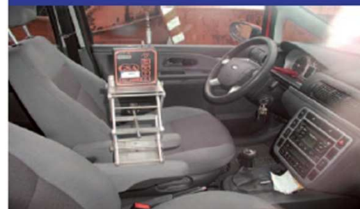
Misurazione all'interno dell'Abitacolo della presenza di gas inquinanti nel veicolo
